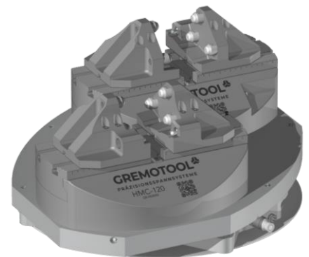
Backe: 2x 837703-B120 Spannmittel: 2x HMC-120
